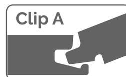
Assemblage par emboîtement, et à frapper sur le petit côté
