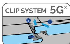
5G® : Un système de clip qui verrouille les lames entre elles. Le système de clip 5G® permet une installation rapide et facile. Une languette en plastique renforcée intégrée au petit côté de la lame permet un assemblage robuste et durable, émettant un 'click' et verrouillant ainsi les lames verticalement.
